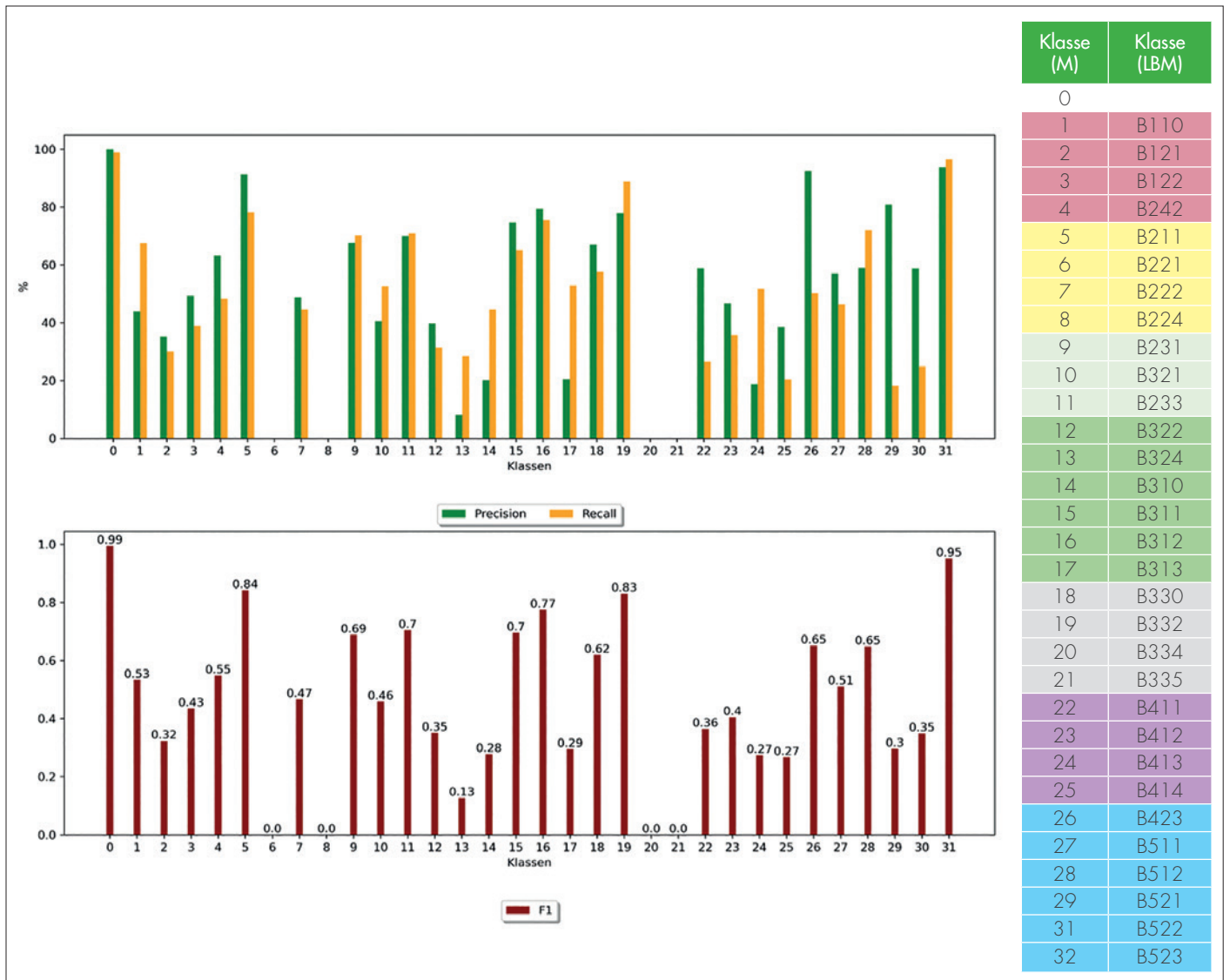
Abbildung 4: Klassenspezifische Gütemetriken für die 31 Klassen des LBM + NoData (0). Aufgetragen sind die gemittelten Werte für Präzision und Recall (oben) sowie F1 (unten) für die Kreuzvalidierung über alle Orbits. Die Klassenzuweisung zwischen Modell (M) und LBM ist in der Tabelle (rechts) zu entnehmen. Die Klassen 6, 8, 20, und 21 sind im Untersuchungsgebiet nicht vorhanden (eigene Darstellung).
