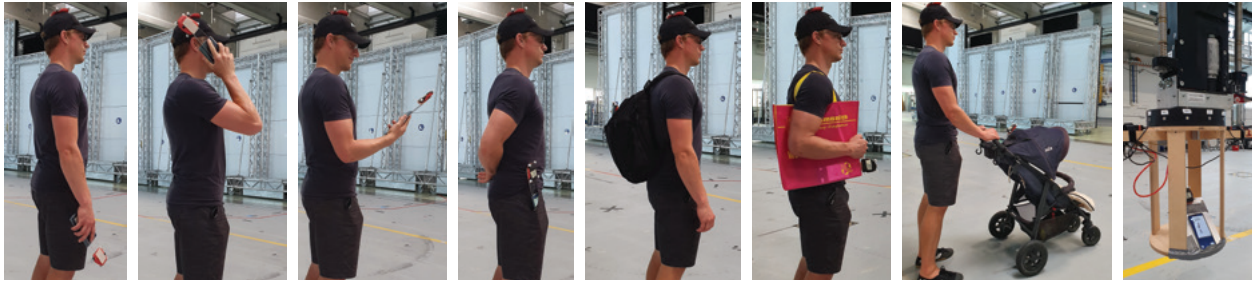
Abb. 4 | Platzierungen des Geräts (oder Gerätepositionen) von links nach rechts: am Arm schwingend, telefonierend, in der Hand, in der Tasche, im Rucksack, in der Handtasche, am Kinderwagen, am 3D-Roboterkran
