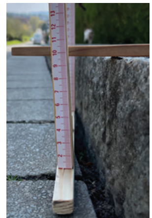
Abb. 7 | Das Abgleichprinzip zur Klassifikation von Borsteinen, reproduziert nach /Heipke et al. 1997/, und das verwendete Messinstrument
