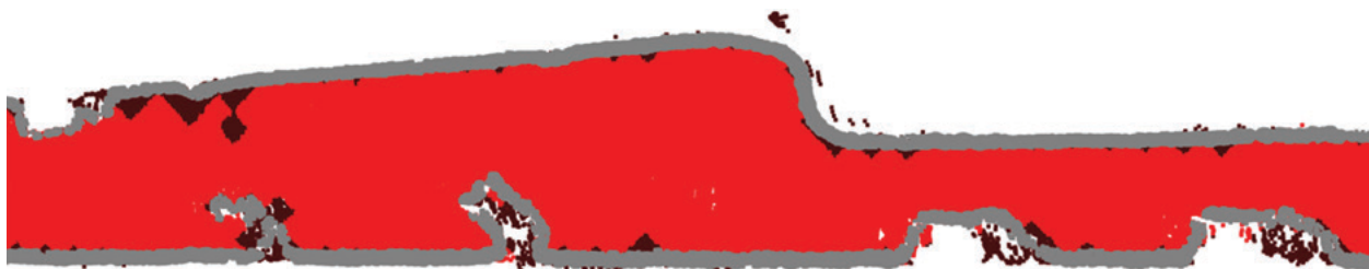
Abb. 5 | Straßenpunkte in Straßenzellen (rot) und Straßenpunkte in benachbarten Nicht-Straßenzellen (dunkelrot), Kandidatenpunkte (grau) nach Rücktransformation der extrahierten Kante in die Punktcloud
