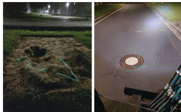
Abb. 7 | An die Umgebung angepasste Projektion eines Tannenbaums (links) und eines Abwasserrohrs inkl. Beschriftung (rechts). Wenn eine Linie nicht projiziert werden kann, da z. B. ein Objekt im Weg ist, so wird der Teil der Projektion ausgelassen.
