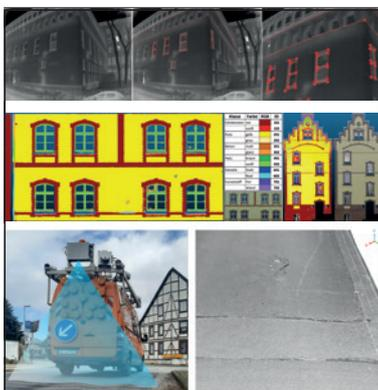
**Oben:** Extraktion von 2D- und 3D-Linienschnittpunkten aus dem Originalbild (links). Nach der Detektion von markanten Liniensegmenten (mittig) in den TIR-Bildern über einen Canny-Operator und anschließende Hough-Transformation werden die Schnittpunkte dieser Linien bestimmt (rechts) (Hoegner et al.).
