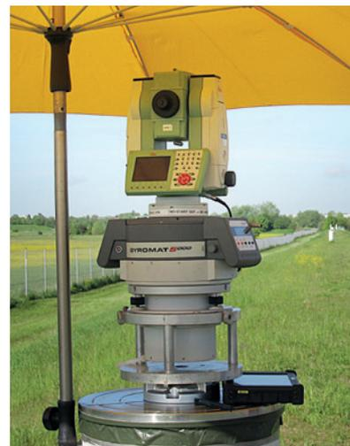
Abb. 2 | DMT Gyromat 5000 mit adaptierten Leica TS15 auf dem Taxiway der UniBw München
