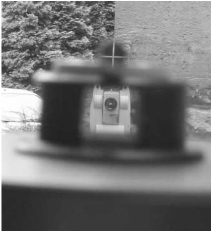
Abb. 3: Ziel im Fadenkreuz Tachymeter im Prisma
