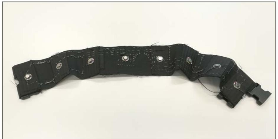
Abbildung 2: Vibrotaktile Gürtel mit acht Vibrationsmotoren
