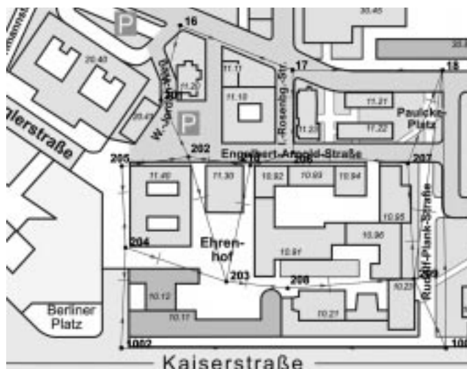
Abb. 2: Mittels N2DPLAN interaktiv erstellter Entwurf des Aufnahmenetzes
