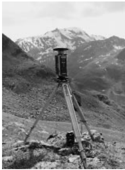
GPS-Messung mit dem Z-Max in der Ölgrube, Kaunertal (Öztaler Alpen, Tirol). Links Vermessung von Punkten (markierten Felsblöcken) am Blockgletscher, rechts Basisstation
