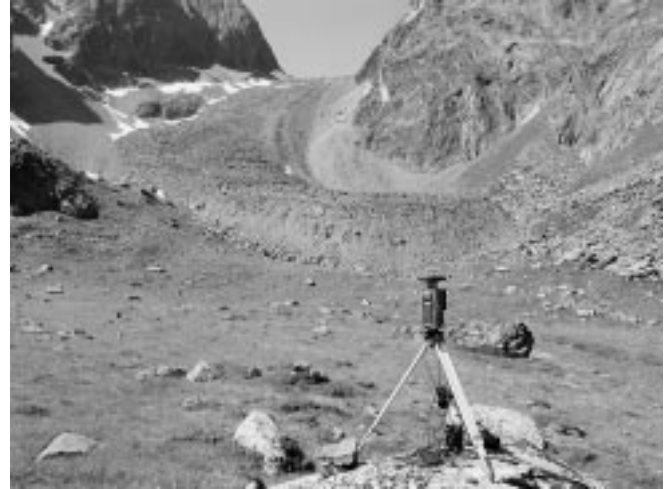
Basisstation für die GPS-Messungen am Blockgletscher im Reichenkar, westliche Stubaier Alpen (Tirol)
