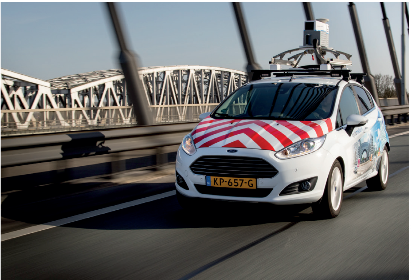
Erfasste rund 3 000 Kilometer Leitungen im Versorgungsnetz der evm-Gruppe: das mobile Cyclomedia-Kamerasystem
