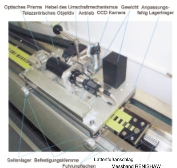
Abb. 2: Messwagen auf dem Komparatoruntersatz mit einer kodierten Invarnivellierlatte von Zeiss
