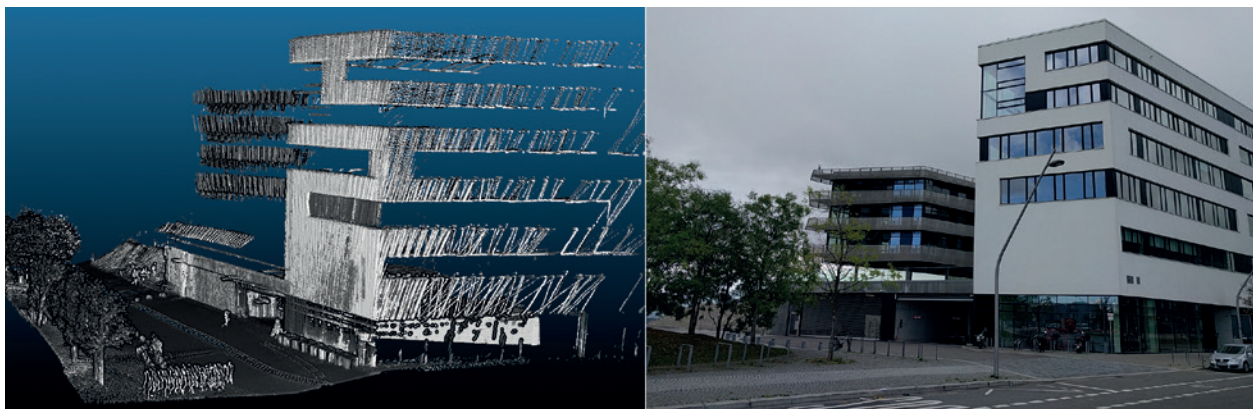
Abb. 5 | Punktwolke aus der HafenCity, Bereich vor dem Universitätsgebäude
