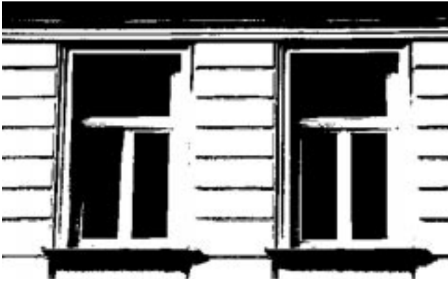
Abb. 5: Originalbild nach Histogrammstreckung und Schwellwertoperator (Schwelle = 125)
