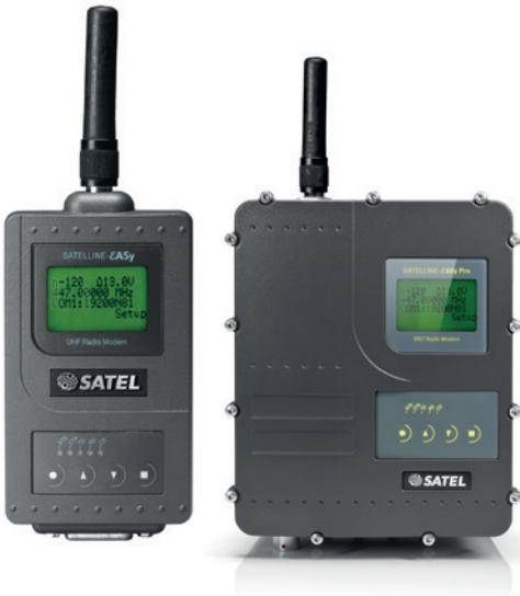
Für die Korrekturdatenübertragung im beschriebenen Projekt sorgen die UHF-Modems Sateline-EASy (links), die eine besonders große Frequenzbandbreite unterstützen; Modems der Reihe Sateline-EASy Pro (rechts) erzielen mit einer höheren Sendeleistung eine größere Reichweite
