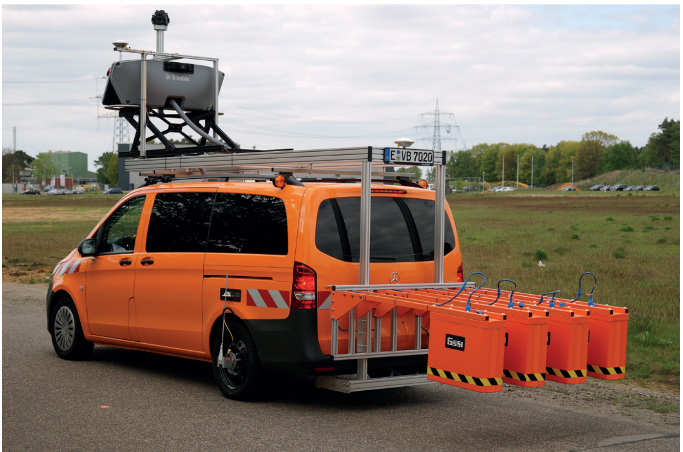
Mobile Mapping System „Trimble MX8“, ausgestattet u. a. mit zwei Laserscannern in Schmetterlingsanordnung, Kameras, INS und Haupt-GNSS-Antenne, im Einsatz für eine Straßenbefahrung der Stadt Essen zur Erstellung von präzisen 3D-Daten
