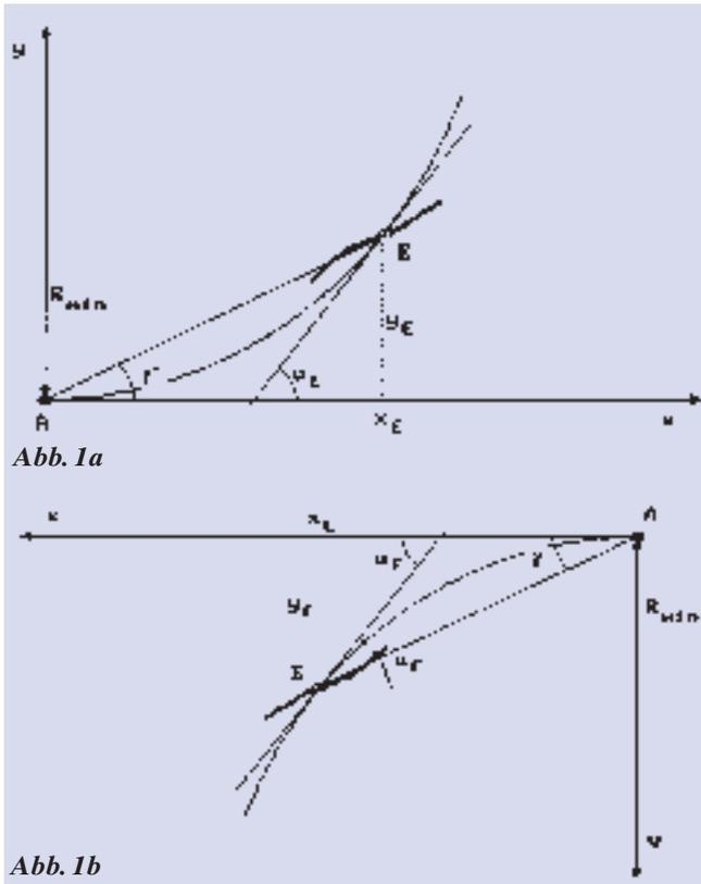
Abb. 1: Gradientenfestlegung mittels der quadratischen Parabel
