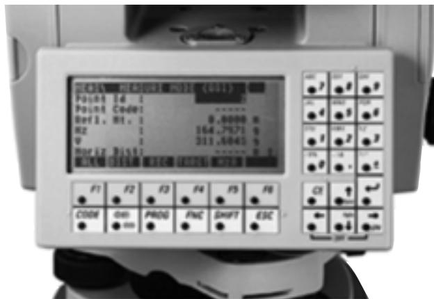
*Bild 2: Eine der möglichen Menüdarstellungen auf dem Display des TCRA 1103 X-Range*
