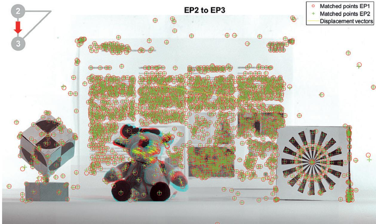
Abb. 5 | Ergebnis des Feature-Matchings zwischen zwei Epochen
