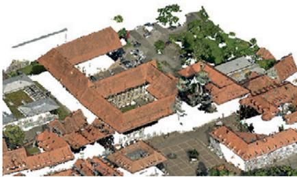
Punktwolke aus UAV-Nadir-Aufnahmen, georeferenziert mit dem ImageVector UAV-RTK
