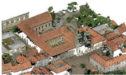
Punktwolke der UAV-Nadir- und Obliqueaufnahmen (Kameraschwenk 25 °)
