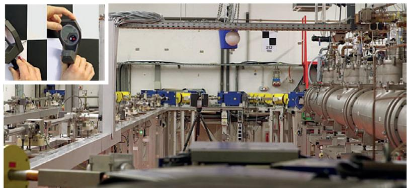
Abb. 4 | 3D-Scan mit FARO Focus3D S 120 zwischen Hauptbeschleuniger und erster Rezirkulation; links oben: Surface Reflector zur Erfassung der Schachbrettmarken mit dem Lasertracker Leica AT401
