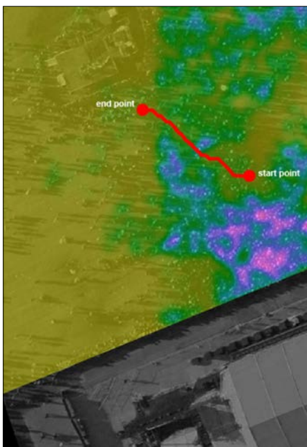
Abbildung 8: Berechnung einer Geringsten-Kosten-Route vom Start- zum Endpunkt basierend auf dem abgeleiteten Menschendichtebild (Hillen et al. 2015)
