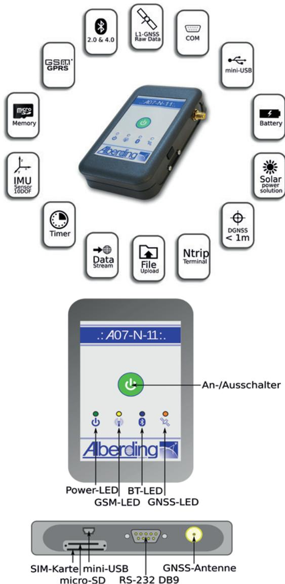
Abb. 3 | Funktionalität und Schnittstellen des A07 /Alberding 2016/
