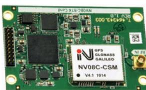
Abb. 2 | Spezifikation der L1-GNSS-Empfänger-Boards uBlox und NVS (EVK)
