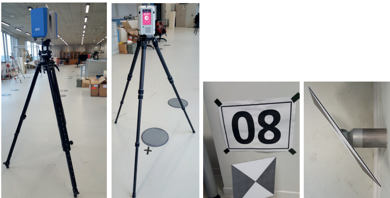
Abb. 2 | Terrestrische Laserscanner Z+F IMAGER 5016 (links) und Leica RTC360 (Mitte) im 3D-Testfeld, Zielzeichen (rechts)
