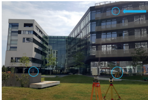
Abb. 10 | Schematischer Messaufbau des Feldprüfverfahrens (links, nach DWV-Merkblatt 07-2014) und Übersicht des Messaufbaus vor dem HCU-Gebäude (rechts)
