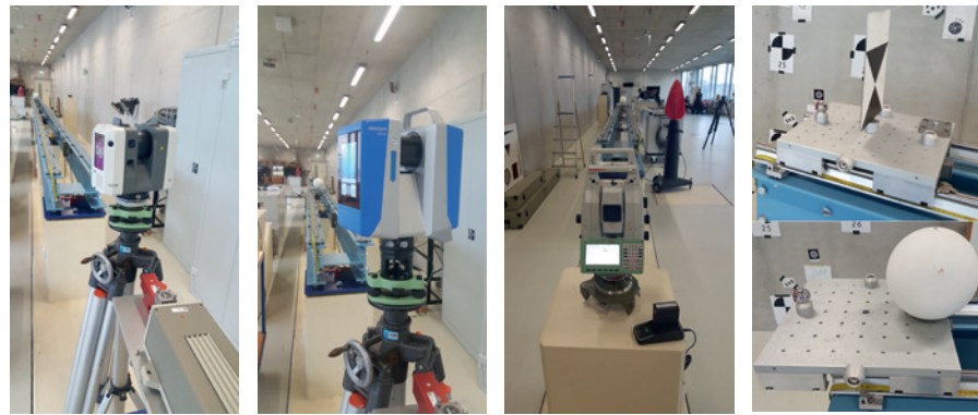
Abb. 5 | Von links: Leica RTC360, Z+F IMAGER 5016, Leica TS60 (Referenzmesssystem 2019) sowie Zielzeichen und Kugel auf dem Schlitten
