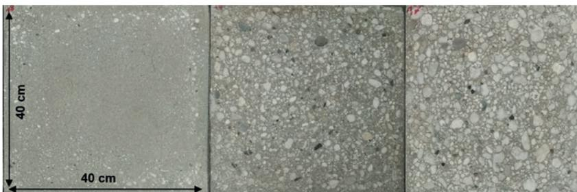
Abb. 11 | Eine repräsentative Auswahl der untersuchten Betonplatten. Links: Platte mit feiner Körnung, Mitte: Platte mit mittlerer Körnung, rechts: Platte mit grober Körnung.
