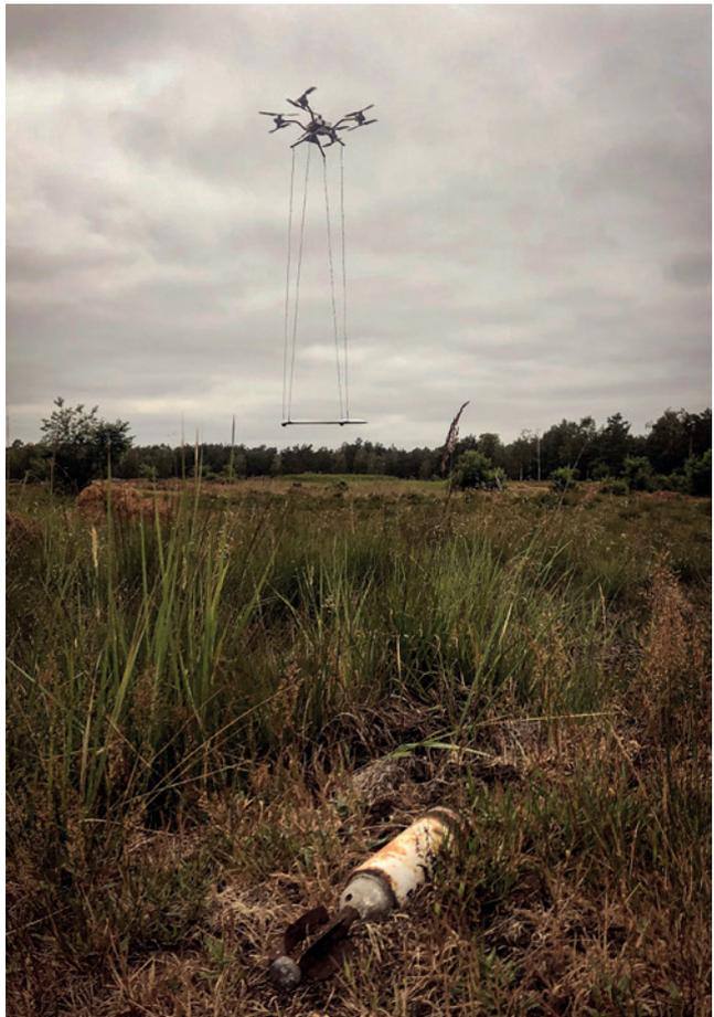
Asdro-Drohnen-Geomagnetik-System für die Kampfmittelsondierung
