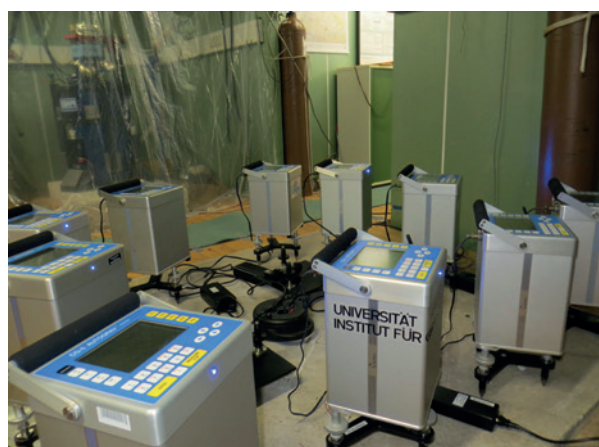
Abb. 2 | Zehn Scintrex CG-5 auf dem Pfeiler C im Messlabor Bad Homburg sowie das SG044 auf Pfeiler E (hinten links)
