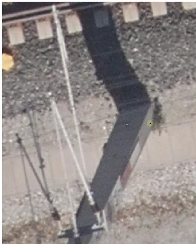
Abb. 12 | Beispiele für die Sichtbarkeit von zwei Mastbolzen in den Luftbildern; weißer Punkt = Sollposition aus der Gleisdatenbank (die gelb-schwarze Messmarke wurde zur Seite geschoben, um den Messpunkt nicht zu verdecken)
