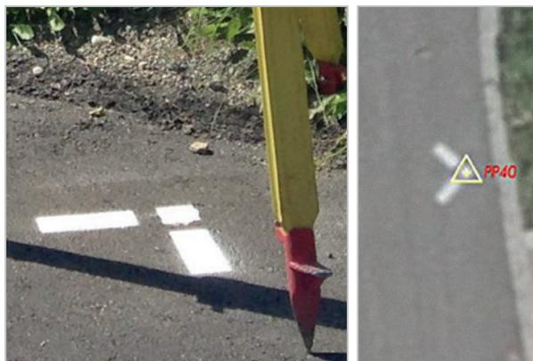
Abb. 4 | Beispiel für einen signalisierten Passpunkt: links: Einmessung, rechts: Luftbild
