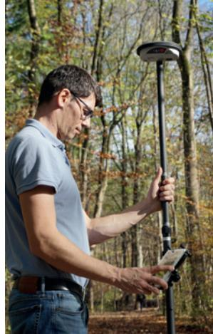
Die neue SmartAntenne Leica GG04 plus verfügt über mehrere Bluetooth-Anschlüsse für die Kopplung mit Leica-Zeno-Endgeräten oder anderen Mobilgeräten mit Windows-, Android- oder iOS-Betriebssystem.
