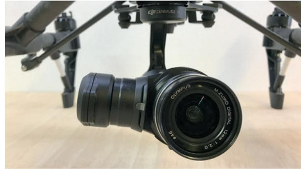
Abb. 1 | DJI-Kameras: Phantom 3 Professional (links) und Zenmuse X5 mit Olympus-Objektiv M. Zuiko Digital ED 12/2.0 (rechts)
