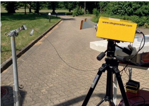
**Abb. 19** | Messanordnung zur Frequenzbestimmung des IBIS-L über die gesamte Frequenzbandbreite im Außenbereich der PTB. Links ist die Hochfrequenzantenne der PTB zusehen
