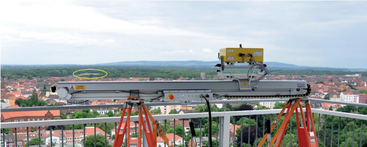
Abb. 4 | Standort des IBIS-L für die Messungen zum Testfeld Franzshes Feld (gelbe Markierung) in 2000 m Entfernung
