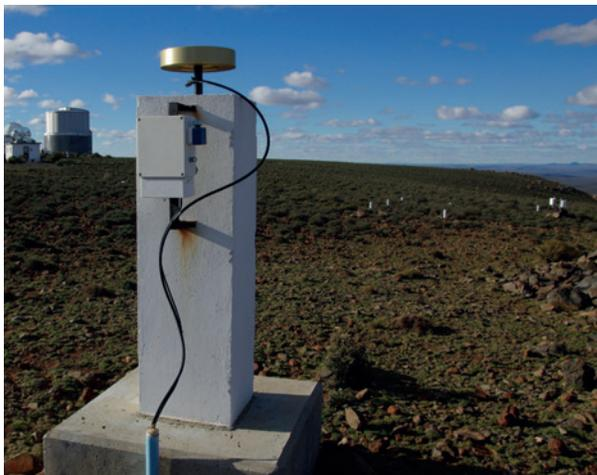
Abb. 5 | Vordergrund: Geodätische GNSS-Station in Sutherland, Südafrika. Hintergrund (rechts): In-situ-Bodenfeuchtesensoren (Quelle: GFZ)
