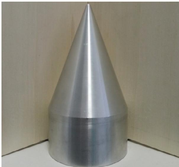
**Abb. 9** | Mittels CNC-Fräse gefertigter Aluminiumkegel
