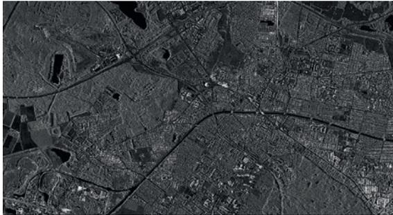
Abb. 7 | Amplitudenbild der Aufnahme D3 in der Entfernungsgeometrie. Die Beleuchtungsrichtung ist von rechts nach links.
