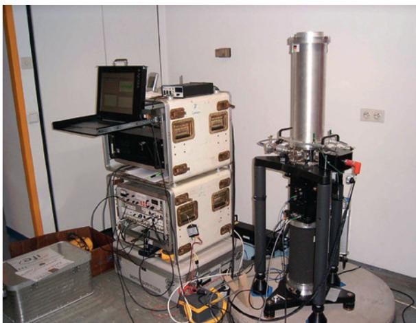
Abb. 11 | Das Absolutgravimeter FG5-220 des Instituts für Erdmessung auf dem DSGN94-Punkt 4/1 in Hannover Buchholz (Geozentrum Hannover)
