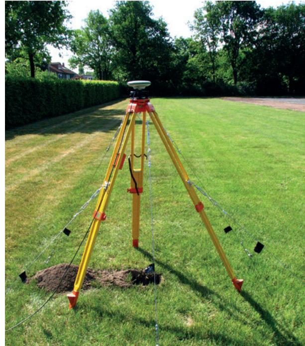
Abb. 2 | Situation an Station 3000: Geodätische Rover-Antenne auf Stativ, Stativbeine mit Stahlseilen abgespannt nach Vorbild des Instituts für Ingenieurgeodäsie und Messsysteme der TU Graz /Brunner 2010/
