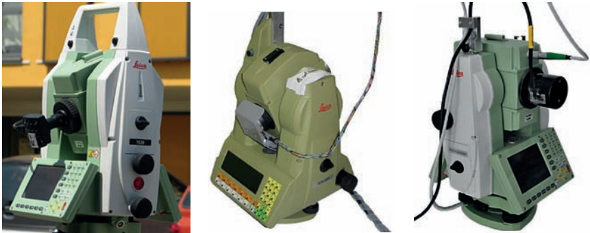
Abb. 13 | Aktuelle Videotachymeter-Systeme aus der Forschung: MoDiTa /Hauth et al. 2012/, DAEDALUS /Bürki et al. 2010/, IATS2 /TU München/
