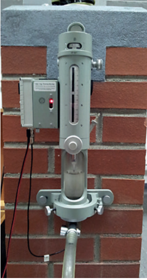
Abb. 2 | Schlauchwaage mit Indikator
