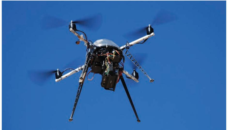
**Abbildung 1:** MikroKopter (Quadro XL) mit der Stereokamera Fujii FinePix Real 3D W3 im Flug über das Ausgrabungsgelände bei Doliche (Foto: R. Dylka 2012)
