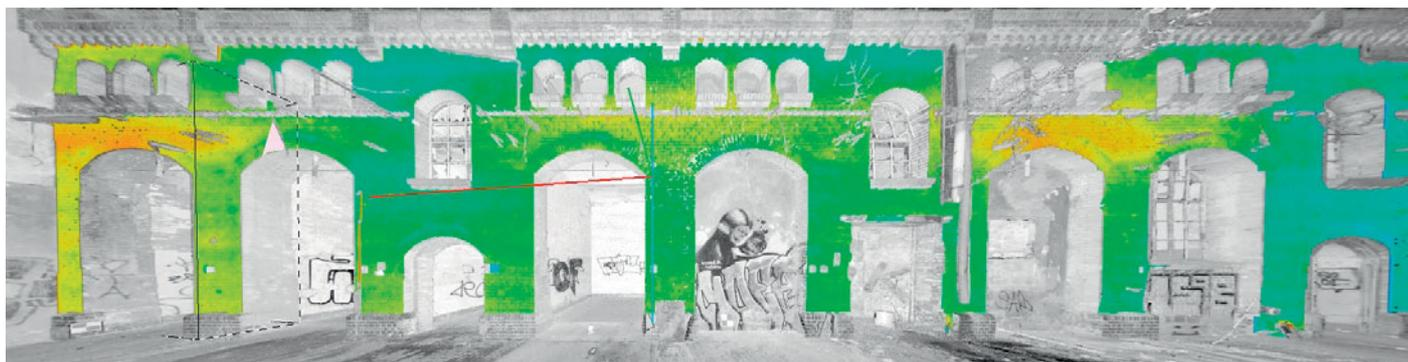
Darstellung der Ebenheit von Bauteilen: Rote Bereiche liegen 2,5 cm vor der Referenzebene, blau eingefärbte Bereiche 2,5 cm dahinter.
