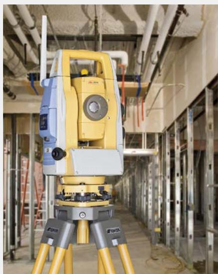
Die Topcon IS-310 Imaging Layout Station verwendet zwei integrierte Kameras, um die Baustelle zu „sehen“. Die Bedienung erfolgt über einen Tablet-PC, der ein Live-Video-Bild von der IS-310 überträgt. Quelle: Topcon
