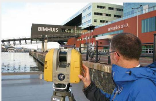
Der Topcon Laserscanner GLS-2000 wird per Touchscreen gesteuert und erfasst eine 360°-Aufnahme inkl. Farbbildern in unter drei Minuten. Quelle: Topcon
