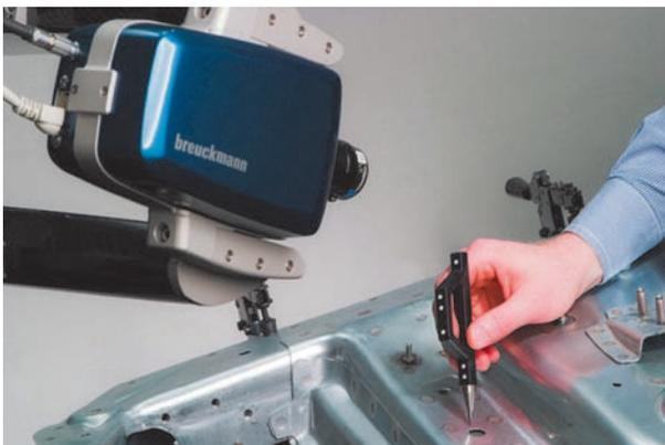
Ein kleiner handgehaltener Messtaster macht diese Aufgabe jetzt noch komfortabler: Die MI.Probe mini. Sie wurde speziell für Messungen mit dem breuckmann stereoSCAN entwickelt. Nur 15 cm groß, ertastet sie alle geometrischen Feinheiten und gibt die Daten an die Auswertesoftware weiter. Es sind weniger Aufstellungen notwendig, die Messung ist unkomplizierter und noch schneller.
