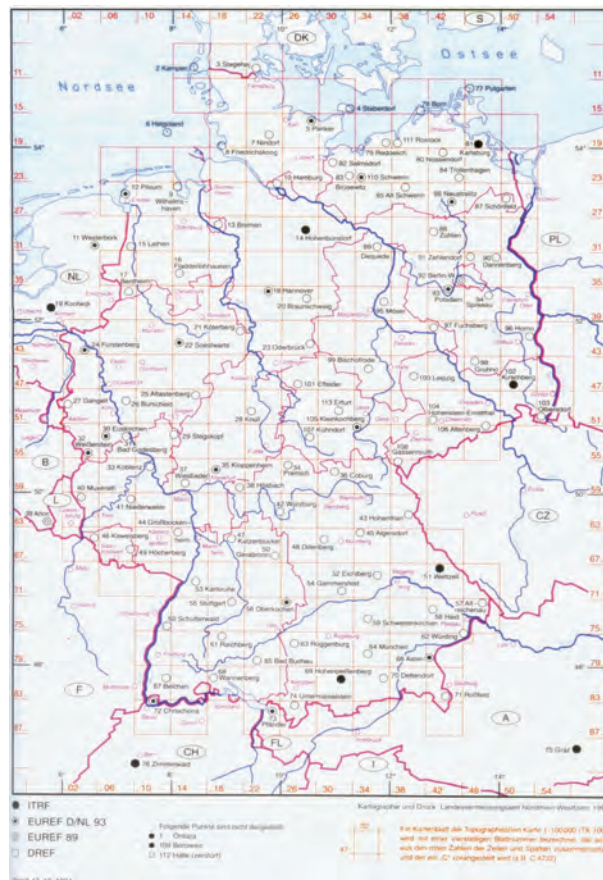
Abb. 6 | DREF91: Deutsches Referenznetz im ETRS89 (aus /Lindstrot 1999/)
