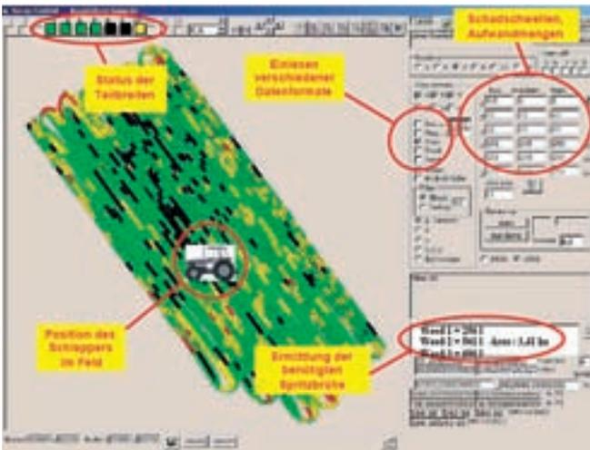
Abb. 4: Dreikammer-Pflanzenschutzspritze mit Teilbreitenschaltung, regelbarer Ausbringungsmenge, GPS-Anschluss und Bedieneinheiten des Steuerungscomputers.
