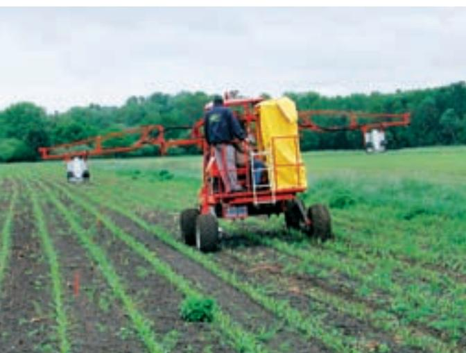
Abb. 1: Trägerfahrzeug mit Bisppektralkameras, dGPS-Empfänger und Bordrechner.
