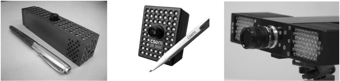
Abb. 2: Einige der zurzeit auf dem Markt verfügbaren RIM Kameras: SR-2 (links), SR-3000 (Mitte), beide von CSEM (Schweiz) und eine 3k-S von PMD Technologies (Deutschland). Die untersuchten Kameras von CSEM haben ca. 20 000 (SR-2) bzw. 25 000 (SR-3000) Pixel. Die 3k-S besitzt ca. 3000 Pixel (eine ca.19 000-Pixel-Kamera ist auch von PMD verfügbar). Alle Sensoren sind standardmäßig auf 7,5 m Messdistanz ausgelegt.
