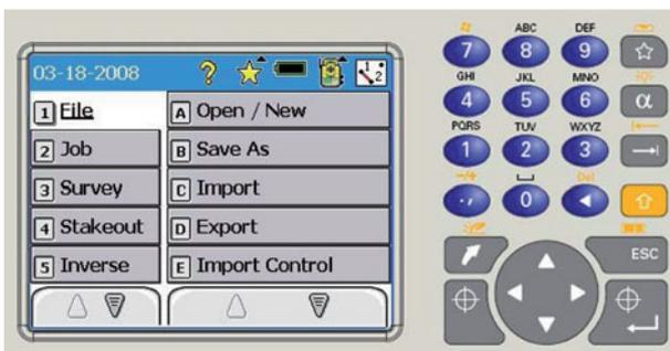
Abb. 2 | Bedieneinheit mit Survey Pro™ Menü
