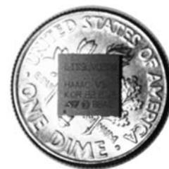
Abb. 8 | MEMS Beschleunigungssensor im Größenvergleich
