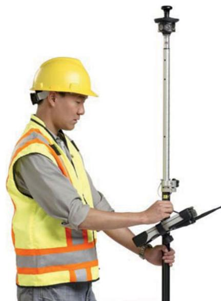
Abb. 5 | Kabelloser Lotstab mit Ranger Bedieneinheit
