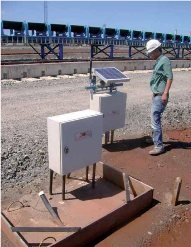
**Bild 17: Settlement-Profiler Endplatte und Festpunkt mit Ausgleichsbehälter für Setzungsmesspunkte (links) sowie Datenlogger mit autarker Stromversorgung über Solarzellen und Funkmodul**
