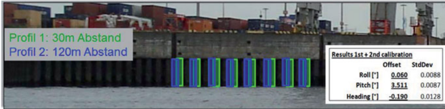
Abb. 5 | Lagewinkel-Kalibrierung (Heading) an einer Mole durch Vergleich verschiedener Scandaten (Profil 1 & Profil 2) mit unterschiedlichen Abständen und Ergebnisse der Kalibrierung
