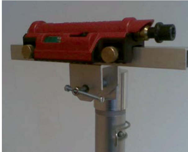
Abb. 2b | Richtungslaser mit Klemmschraube für vertikale Neigung
