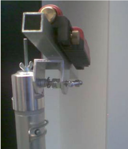
Abb. 2a | Richtungslaser auf obersten Rohrelement
