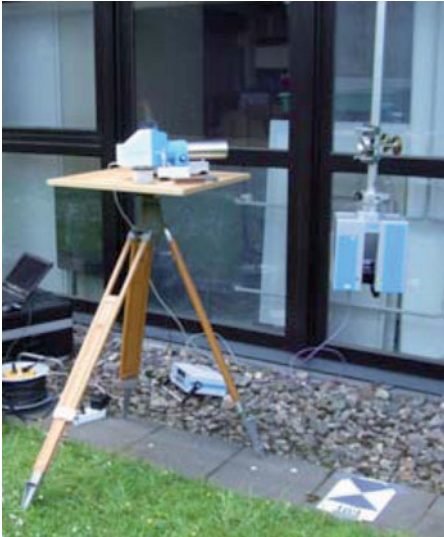
Abb. 5 | Messung der Eigenrotation durch Autokollimation
