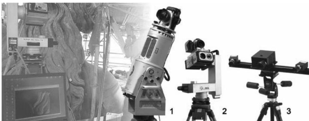
Abb. 1: Verschiedene 3D-Scanner, die sich vor allem durch die Kombination mit hochauflösenden digitalen Spiegelreflexkameras für den Einsatz im Denkmalpflegebereich besonders bewährt haben. (1) Laserscanner Riegl LMS-Z420i (2) Laserscanner LPM 25-HA (3) Hochauflösender Streifenlichtscanner PT-M1024. Ganz links: Arbeitsbild mit Laserscanner bei der Vermessung der monumentalen Statue der Bavaria (München). Grafik: © 2007, ArcTron 3D GmbH
