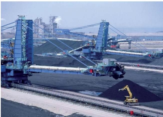
**Bild 1:** Erzlager mit Stacker/Reclaimer (Europoort Rotterdam)
