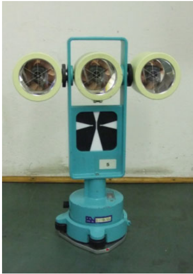
Abb. 2 | Mekometer-Reflektor mit aufgesteckten Zusatzreflektoren
